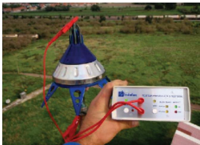
Photo VI : vérification d'un PDA situé en haut d'un bâtiment (Indelec)
