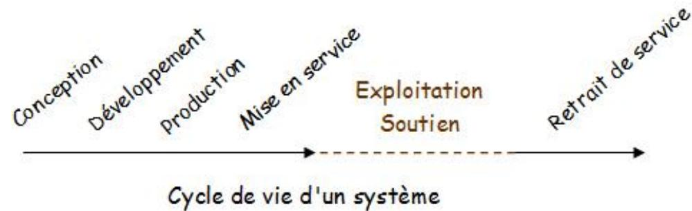
Système = Système principal + Système de soutien (documentation et données, rechanges, équipements de test et de maintenance...)
